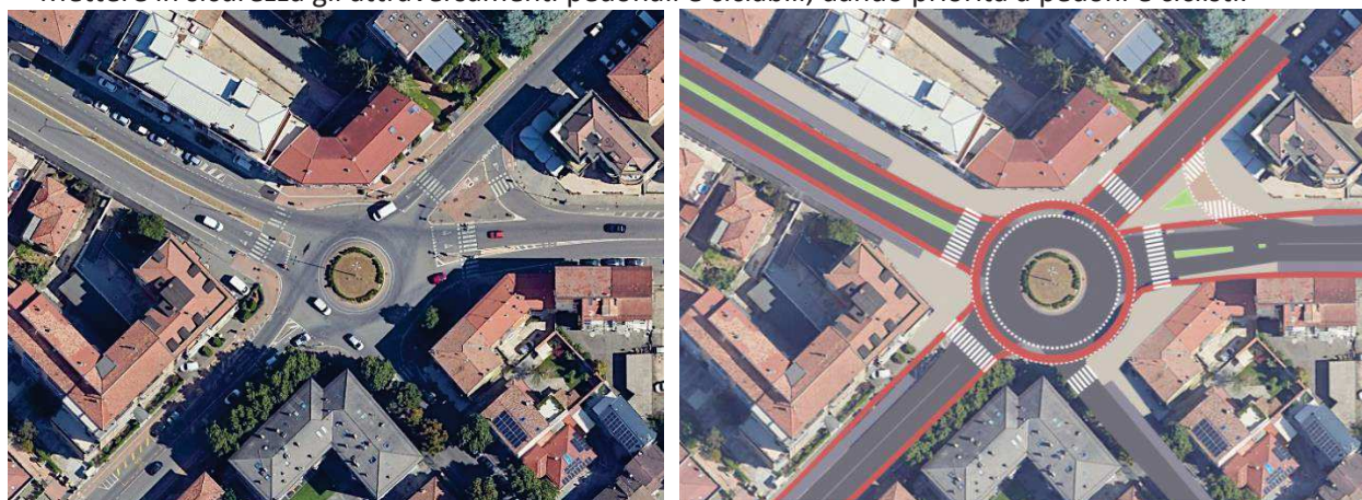
Figura 5-12: Schema di riqualificazione e messa in sicurezza del nodo via Vittorio Veneto e via Gadolini
