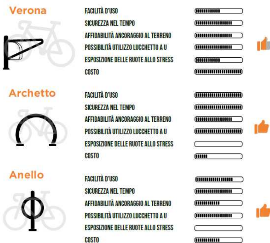
Figura 5-15: Rastrelliere con aggancio della bici all'altezza del telaio
