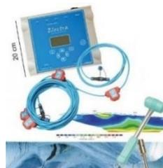
In pratica, il rilievo consiste nel posizionare gli elettrodi nel terreno secondo *arrays* 2D o 3D e, quindi, nell'effettuare il collegamento ai *take-out* dei cavi che portano il segnale (di *input* ed *output*) all'unità di misura. Dal software vengono poi impostate la configurazione prescelta e i relativi parametri geometrici (passo di misura, numero di misure, ecc.).
