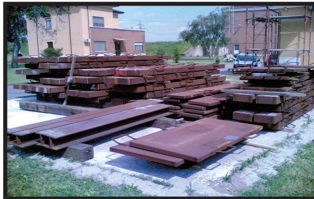
PARATOIE PER CHIUSURA VARCHI DAL n.3 al n. 11 AREA DI STOCCAGGIO PRESSO IMPIANTO IDROVORO FINARDA –
